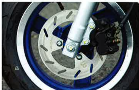
Vorne bremst man mit einer 200er Scheibe, hinten eine herkömmliche Trommelbremse.
