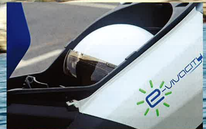
Durch die Batterie darunter passt leider nur ein kleiner Jethelm unter die Sitzbank.
